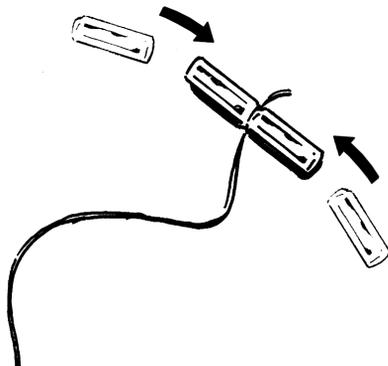
ПД 3: подвесьте магниты на нити. С помощью компаса определите северный брусок. Пометьте его маркером.
