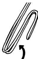
ПД 6: измерьте длину ствольной коробки и загните на этом расстоянии опорный крюк.
